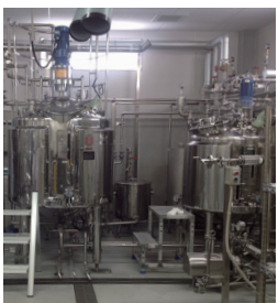
第1工場 500kg 1000kg 発酵用タンク
